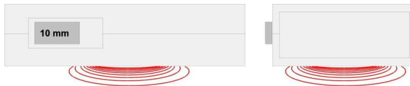
Vue latérale : Champ de mesure et profondeur de pénétration en position de commutateur „10 mm“
