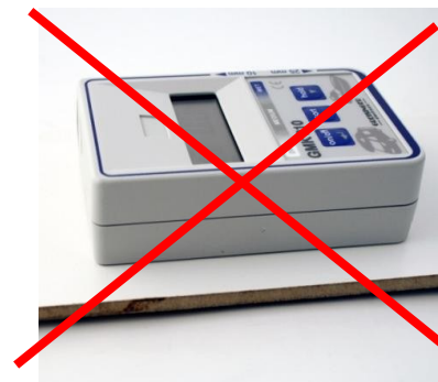
Mal: Épaisseur du matériel insuffisante
