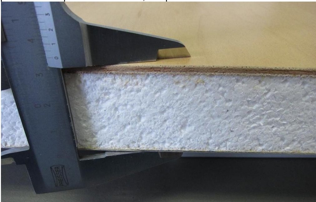
Exemple sandwich: aluminium- isolement - contreplaqué
