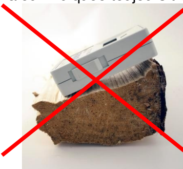
Mal: Surface irrégulière
