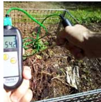
*Mesurez la température du compost avec un thermomètre de la série Therma et une sonde thermocouple Ch133-136, longueur 1000mm, diamètre 9.5mm, donne la température en moins de 17 secondes*
