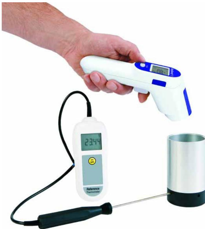
sée pour compenser les différences mineures dans les lectures de l'instrument de test. Ensuite, seuls les instruments avec des erreurs inacceptables doivent être retournés au fournisseur pour le réétalonnage ou la certification.
