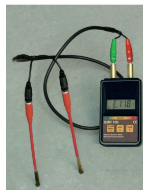
GMR 110 avec câble de mesure et sonde pinceau en option pour matériau dur
