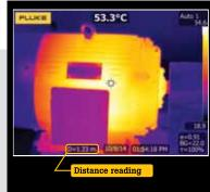
La mise au point automatique LaserSharp® utilise un télémètre laser intégré qui permet de calculer et d'afficher la distance de votre cible avec une précision chirurgicale.
