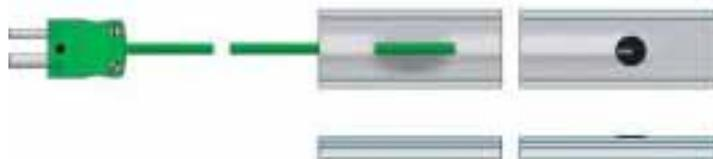
Exemple de sonde thermocouple avec velcro pouvant s'enrouler sur des tuyaux 20 x500 mm, gamme de température -10 à 100°C, temps de réponse 20 sec. Code no CH133-080, prix Frs 40.- ht
